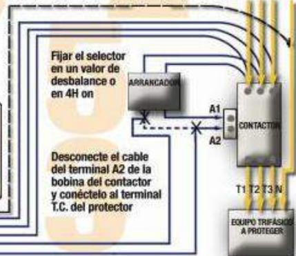
Fijar el selector en un valor de desbalance o en 4H on
